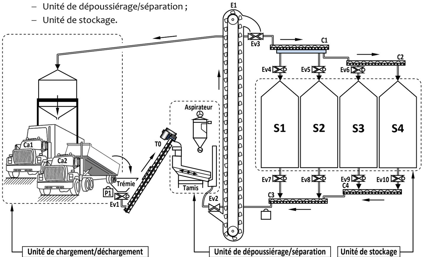
Le blé, transporté par le camion (Ca2) à l'unité de chargement/déchargement, est déchargé dans la trémie, puis acheminé vers le tamis de l'unité de dépoussiérage/séparation en passant par l'électrovanne (EV1) et la vis transporteuse (T0) inclinée à 45°.
